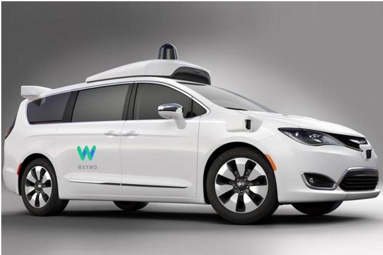
Abbildung 11: Waymos erstes Flottenfahrzeug – Umgebauter Chrysler Pacifica Hybrid Minivan (Quelle: (Waymo, 2021))
