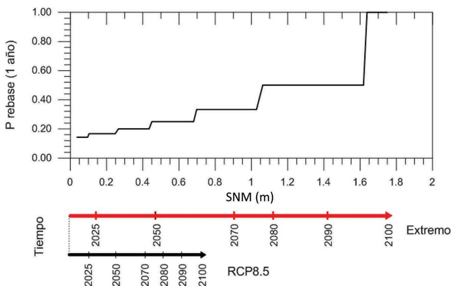
**Figura 13.** Variación de la probabilidad anual de rebalse de la escollera de protección de la vía del tren en el tramo de costa con aguas abajo del Port [Puerto] de Mataró, en función de la subida del nivel del mar. Las dos escalas temporales indican cuando se verificaría el nivel de mar respectivo bajo cada escenario (RCP8.5 y al extremo).
