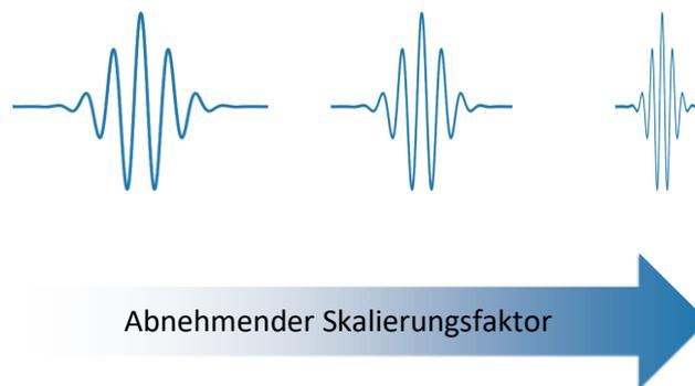
Abb. 30: Einfluss des Skalierungsfaktor, illustriert an dem Morlet-Wavelet (Quelle: Eigene Darstellung)
